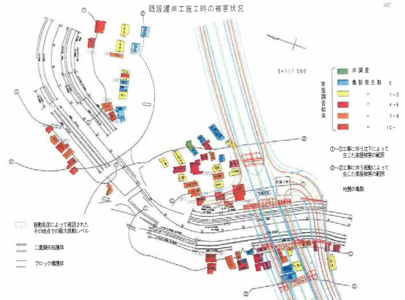
図-1.1 宇治川既設護岸工施工時の被害状況
